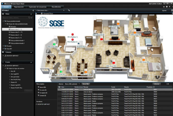
*Captura realizada del plugin de integración de los paneles Risco en Milestone.
