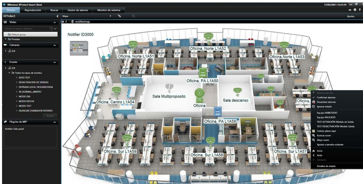
El plugin nos permite también recuperar el tipo de sensor parametrizado en la central de incendios, de manera que el icono que se muestra en el plano cuando se añade el mencionado dispositivo se corresponde con el configurado, lo que nos permite hacernos una idea más clara de la instalación de Fuego al observar el plano. Podremos indicar si el tipo de detector asociado a cada zona es:
