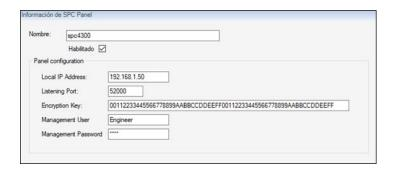
Lorsqu'on souhaitera intégrer plusieurs centrales dans le même Milestone, chacune devra être connectée au plugin via un port différent. A savoir qu'on configurera un port pour l'écoute sur chaque centrale.
