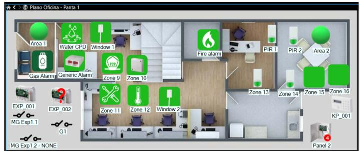
Si ejecutamos el comando de armado forzado sobre el Área 1 que es a la que está asignada la zona Gas Alarm, el plugin inhibirá la zona y armará el Área 1:
