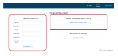
Dispondremos de un entorno de configuración dos partes bien con diferenciadas, ACC registro en У comunicaciones con el panel o paneles Galaxy.
