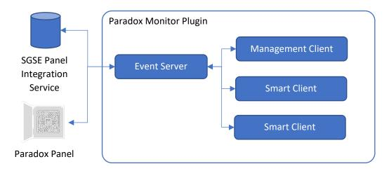
El servicio web gestiona las conexiones con los paneles y expone una API mediante la cual se comunica con el plugin que reside en el Event Server. De esta forma integrará los dispositivos conectados al panel y sus alarmas haciendo uso de la mensajería de Milestone.
