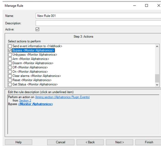
Seleccione una acción (por ejemplo, Bypass) y haga clic en < Monitor Alpatronics > para elegir los elementos involucrados en la acción.
