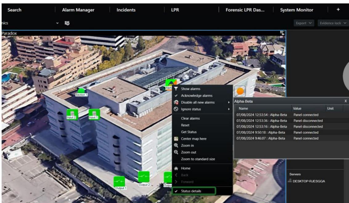
El plugin "*Alpatronics Monitor*" permite monitorear e interactuar con los paneles a través de la interfaz de usuario estándar de XProtect® Smart Client.
