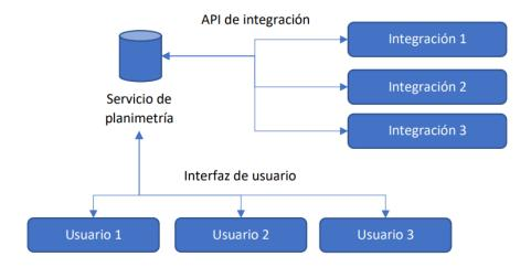
Por un lado, el servicio web expone una API de integración que se utiliza para transmitir al servicio de planimetría los datos sobre los dispositivos que se quieren integrar. Por otro lado, expone una interfaz de usuario mediante la cual se pueden crear planos y representar los dispositivos que se han registrado mediante la API de integración.
