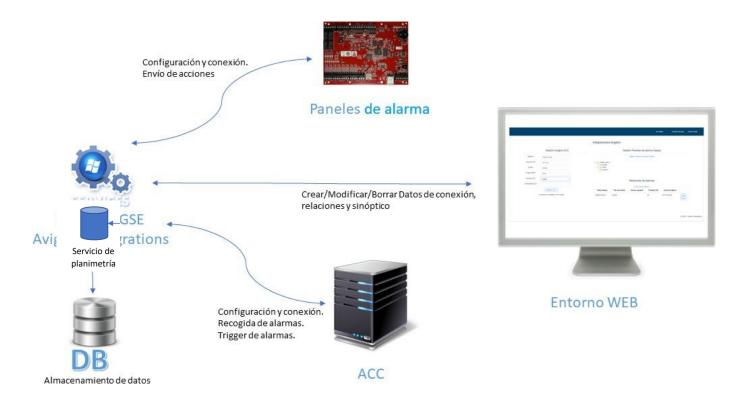
Además, el Monitor SPC es interactivo, permitiendo la toma de acciones sobre las particiones, zonas y salidas configuradas en los diferentes paneles SPC por mediación de un panel sinóptico, el cual también nos ayuda a comprobar el estado del panel en tiempo real. La solución se completa con un servicio web que permite la representación gráfica de los distintos dispositivos integrados en uno o varios planos, así como sus estados, permitiendo interactuar con ellos.
